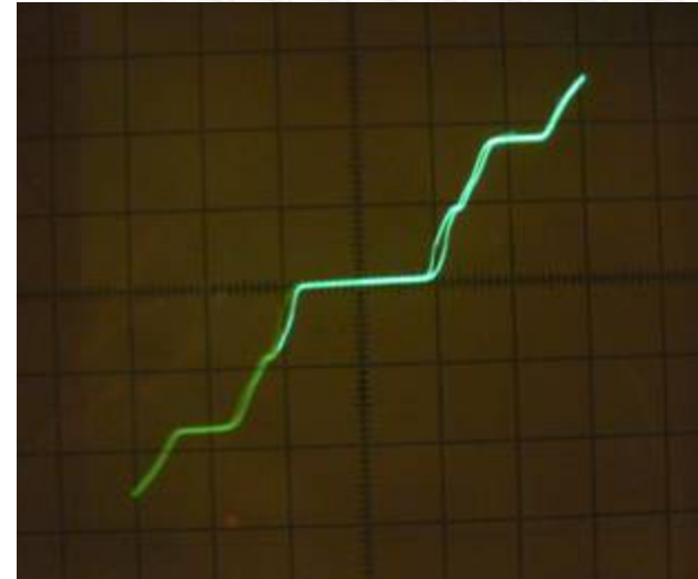
Рисунок 9 – Результаты измерений на матрице Джозефсона с помощью цифрового синтезатора частоты:
